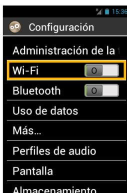
2. Pulse en el botón ENCENDIDO/APAGADO
